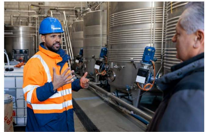
Plus de 600 000 litres d'éthanol peuvent être produits à Aarberg (BE), chaque année. La mélasse fermente au chaud dans des cuves de 9000 litres, puis passe dans un alambic de dix colonnes.
